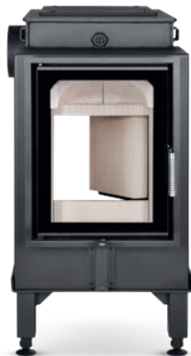
HE 37/50Ga hlboké ohnisko so zadným prikladaním a bočným vývodom pre spaliny Ø180 mm
